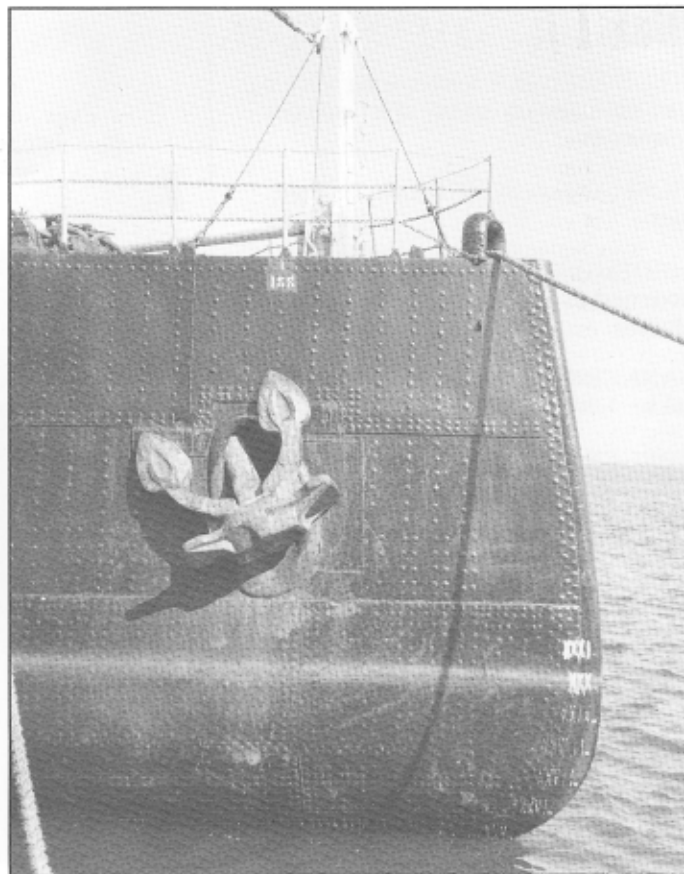
På billedet af »Krasin«s stævn ses tydeligt den kraftige og tætte nitning, der er kendetegnende for en isbryder.
